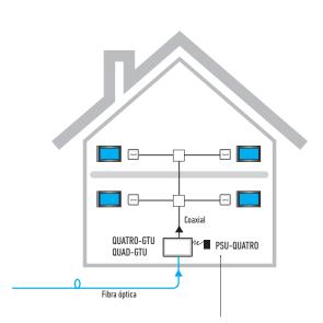
En el caso de no tener alimentación o no ser suficiente la corriente suministrada para telealimentar los receptores ópticos QUATRO o QUAD, habrá que colocar el alimentador externo PSU-QUATRO (4951)
